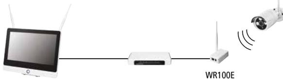
Einsatz eines WR100E (optional erhältlich) als WLAN\*\*-Repeater:
