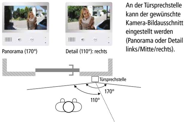
An der Türsprechstelle kann der gewünschte Kamera-Bildausschnitt eingestellt werden (Panorama oder Detail links/Mitte/rechts).
