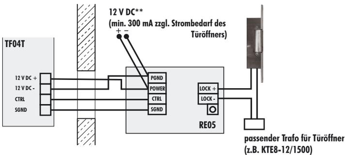
Achten Sie auf die Schaltleistung des Relais: max. 10 A bei 24 V AC/DC.
