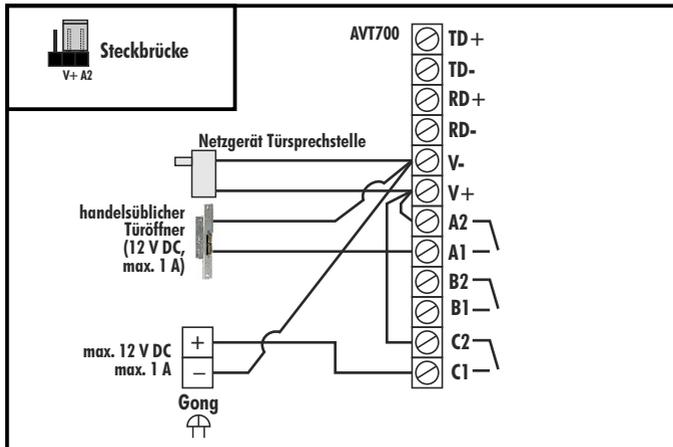
**Achtung:** Max. Stromaufnahme der Türsprechstelle sind 300 mA. Angeschlossene Türöffner (max. 2) und Gong dürfen insgesamt (inkl. Türsprechstelle) 2 A nicht überschreiten (Alternativ: eigene Spannungsversorgung verwenden, siehe oberes Bild).
