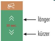
Die Anzeigezeit für manuelles Einschalten der Türsprechstellenkameras bzw. der Zusatzkameras ist zwischen 6 Sekunden und 10 Minuten. Werkseinstellung: 30 Sekunden.
