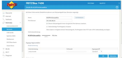
Sie ersehen hier den Name und die IP-Adresse des VT100SIP-Gateways. Es macht Sinn, dass Sie den Haken bei „Diesem Netzwerkgerät immer die gleiche IPv4-Adresse zuweisen“ setzen.
