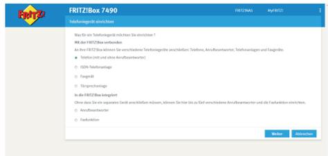
Nachdem Sie mit "Weiter" diese Eingabe bestätigt haben, wählen Sie als Anschluss "LAN/WLAN (IP-Telefon)" aus und geben dem Anschluss einen Namen, z.B. VT100UERSPRECHSTELLE.
