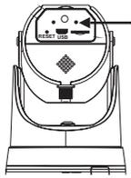
Kamera über microUSB-Kabel in Routernähe mit 5 V DC versorgen. Blaue Verbindungs-LED blinkt dreifach in regelmäßigen Abständen. Falls LED nicht blinkt, Hardreset durchführen (Reset-Taste 1 min gedrückt halten)
