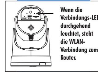
Wenn die Verbindungs-LED durchgehend leuchtet, steht die WLAN-Verbindung zum Router.
