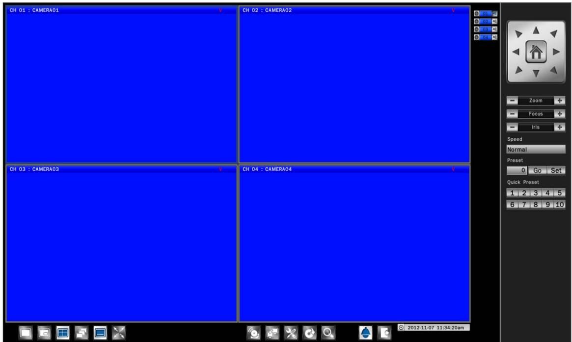
Die PTZ-Steuerung wendet die Befehle auf den aktuellen Kamerakanal an, wenn an diesen eine PTZ-Kamera angeschlossen ist.
