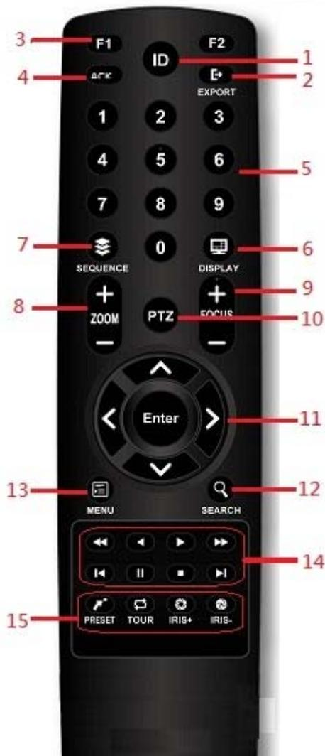
1. **ID:** Drücken Sie die ID-Taste + Zifferntaste, um auf den DVR zu schalten, der gesteuert werden soll. Drücken Sie auf eine Ziffer zwischen 1 und 9, entsprechend der ID des Gerätes, das gesteuert werden soll. Die Benutzer-ID muss zuvor im Gerät eingestellt worden sein.
