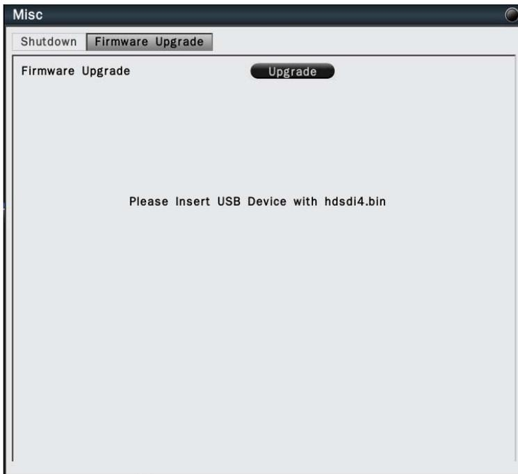
Um ein Upgrade der Firmware durchzuführen, schließen Sie einen USB-Stick an, der die Version der Firmware enthält, die Sie aktualisieren möchten.
