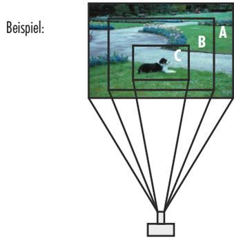
Der horizontale Erfassungswinkel ist Objektiv- und Sensorformat-abhängig. Er wird in den Technischen Daten der Kamera bzw. des Objektivs angegeben.
