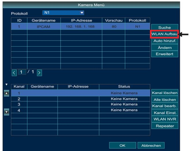
Das folgende Fenster öffnet sich, und die WLAN-Verbindung zwischen Recorder und Kamera wird aufgebaut:
