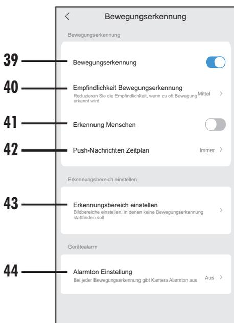
**[39] Bewegungserkennung:** Stellen Sie den Schieber hinter "Bewegungserkennung" nach rechts, um die Bewegungserkennung zu aktivieren. Wenn der Schieber links steht, sind alle Untermenüs der Bewegungserkennung ausgeblendet und keine Einstellungen möglich.
