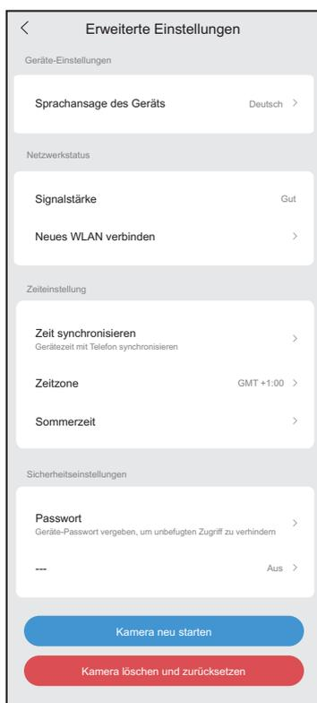
**Signalstärke:** Bei einer guten WLAN-Verbindung zum Router wird hier "Gut" bzw. "Sehr gut" angezeigt. Sollte hier "Schlecht" stehen, kann das Bild verzögert angezeigt werden bzw. die Verbindung zur Kamera unterbrochen werden. In diesem Fall sollte ein Repeater eingesetzt oder die Kamera näher beim Router platziert werden.
