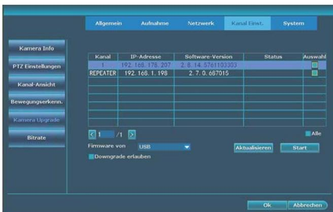
Hier haben Sie die Möglichkeit, die Firmware Versionen der Kameras und Repeater/Access Points auszulesen und bei Bedarf zu aktualisieren. Die neue Firmware kann, wenn verfügbar, über USB aufgespielt werden.
