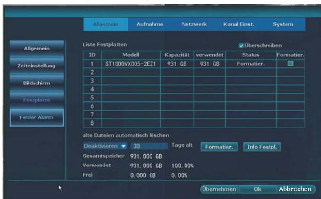
Sobald eine Festplatte an den Monitor angeschlossen ist, erkennt das System automatisch, ob die Festplatte in Ordnung ist. Wenn keine Festplatte angeschlossen ist, das interne Verbindungskabel oder die Festplatte nicht in Ordnung sind oder das falsche Netzgerät verwendet wird (Monitor-Netzgerät mit 12 V, 3 A muss angeschlossen sein), wird
