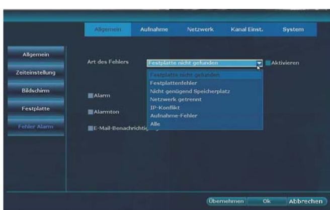
Um eine Meldung (Alarm-Icon, Alarmton, Email) im Fehlerfall zu erhalten, wählen Sie die Fehlerart über das Dropdown-Menü hinter "Art des Fehlers" aus: Festplatte nicht gefunden, Festplattenfehler, Nicht genügend Speicherplatz, Netzwerk getrennt, IP-Konflikt, Aufnahme-Fehler oder Alle.
