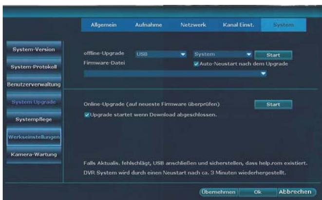
Hier haben Sie die Möglichkeit, die Firmware des Monitors zu aktualisieren. Diese kann, wenn verfügbar, über einen USB-Stick (max. 32 GB) aufgespielt oder aus dem Internet heruntergeladen werden.
