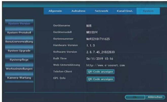
Hier können Sie Systeminformationen auslesen: Geräte name, Geräte modell, Seriennummer, Hardware-Version, Software Version (Firmware Version), Built Time, Web-Unterstützung (Homepage über die auf das System unter Eingabe von Cloud-ID und Passwort zugegriffen werden kann), Telefon-Client (durch Klicken auf [QR Code anzeigen] kann die Android - oder iOS-App durch Scannen der erscheinenden QR-Codes im Playstore oder Appstore aufgerufen und heruntergeladen werden).
