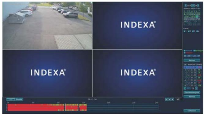
Durch Klicken in den Zeitstrahl können Sie zur gewünschten Uhrzeit springen. Durch Klicken auf [Stunde] oben links über dem Zeitstrahl wird die Ansicht auf die aktuell im Zeitstrahl gewählte Stunde angepasst. Oben rechts über dem Zeitstrahl können Sie:
