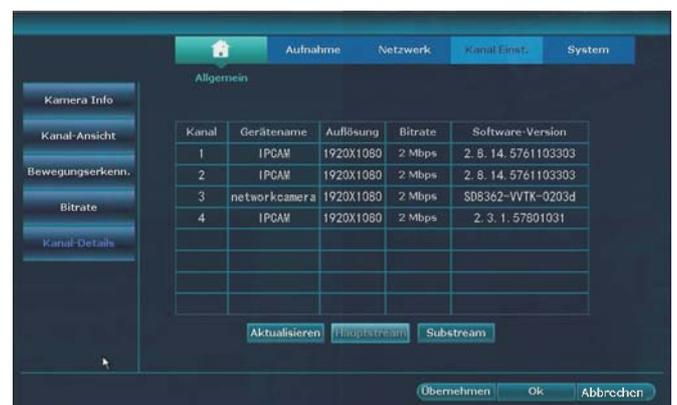
Hier können Sie den Gerätenamen, die eingestellte Auflösung, maximale Bitrate und die Firmware Version der Kamera (Software-
