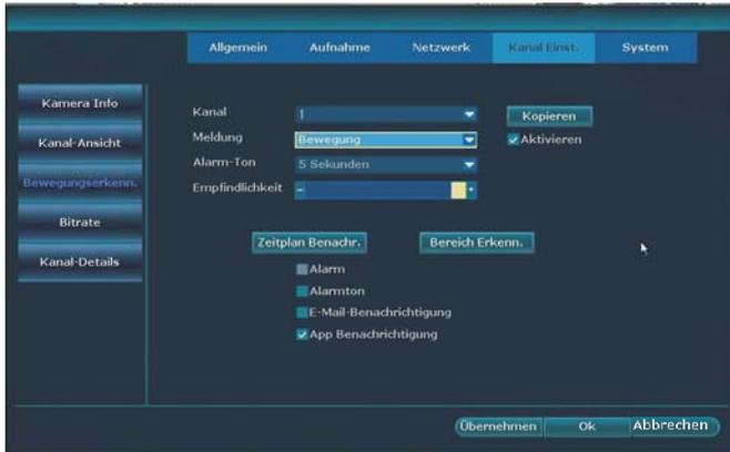
Für jede mit dem Monitor verbundene Kamera kann über das Menü die Bewegungserkennung, eine Meldung bei Signalverlust und/oder ein Privatsphärenbereich eingestellt werden.
