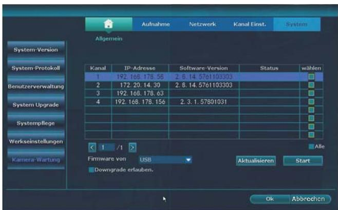
Hier haben Sie die Möglichkeit, die Firmware Versionen der Kameras und Repeater/ Access Points auszulesen und zu aktualisieren. Die neue Firmware kann, wenn verfügbar, über USB aufgespielt werden.
