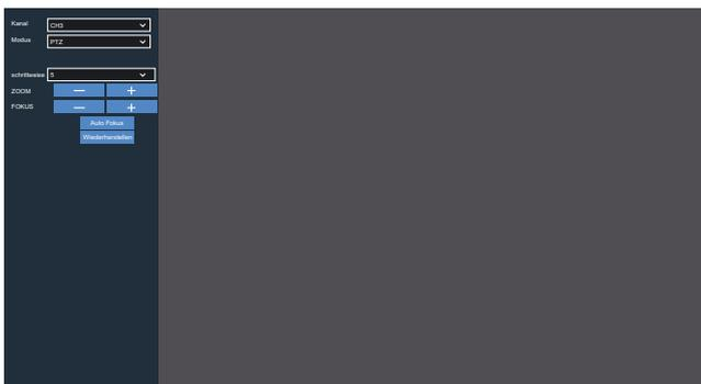
Wenn Sie kompatible Kameras mit Motorzoom und Autofokus verwenden, können Sie über die Funktionen [Zoom + -] oder ▲ / ▼ die Brennweite der Kamera vom Rekorder aus ändern.
