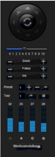
Steuerung der PTZ-Kamera: ermöglicht die Steuerung der Kamerarichtung. Mit der mittleren Taste kann die automatische Schwenkroute gestartet werden.
