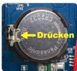
Schritt 5: Nehmen Sie eine neue Batterie mit „CR2032“ nach oben zeigend und installieren Sie sie auf der Hauptplatine.
