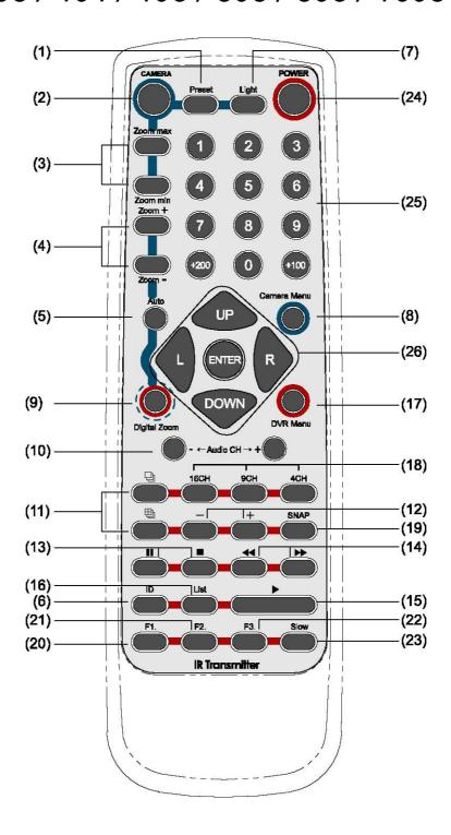
KAMERA Kontrolltasten: Taste (1) bis (8). (Taste (7) wird für die Schaltersteuerung verwendet) DVR Kontrolltasten: Taste (9) bis (23). ANDERE Kontrolltasten: Taste (24) bis (26) unterstützen die Steuerung von KAMERA & DVR.
