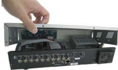
Schritt 1-2: Entfernen Sie die obere DVR-Abdeckung
