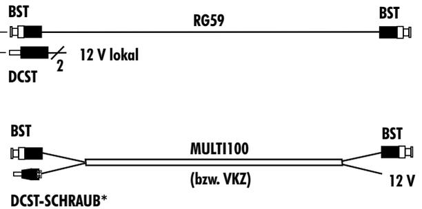
\*DCST-SCHRAUB (DC-Stecker mit 2 Klemmanschlüssen) ist im Lieferumfang der Kamera enthalten
