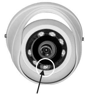
Abb. 3 Dämmerungssensor nach unten ausrichten
