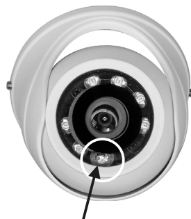
Abb. 3 Dämmerungssensor nach unten ausrichten
