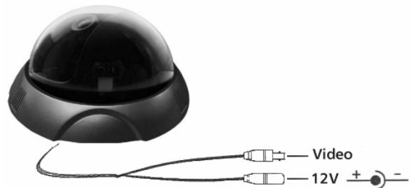
Schließen Sie den BNC-Videoausgang an einen Monitor oder einen Recorder über 75  $\Omega$  Koaxialkabel (z.B. RG 59) und danach die Stromversorgung über die 12V-Buchse an (empfohlene Netzgeräte: NG 1000 oder OTTO 12/500, 12V DC). Beachten Sie die Pol-Anschlüsse.
