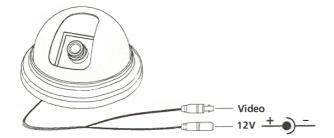
Schließen Sie den BNC-Videoausgang an einen Monitor oder einen Recorder über 75  $\Omega$  Koaxialkabel (z.B. RG 59) und danach die Stromversorgung über die 12V-Buchse an (empfohlene Netzgeräte: NG 500 S oder OTTO 12/500, 12V DC stabilisiert). Beachten Sie dabei die Pol-Anschlüsse.
