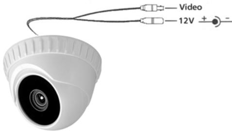
Schließen Sie den BNC-Videoausgang an einen Monitor oder einen Recorder über 75  $\Omega$  Koaxialkabel (z.B. RG 59) und danach die Stromversorgung über die 12V-Buchse an (empfohlene Netzgeräte: NG 500 S, NG 1000 oder OTTO 12/500). Beachten Sie die Pol-Anschlüsse.
