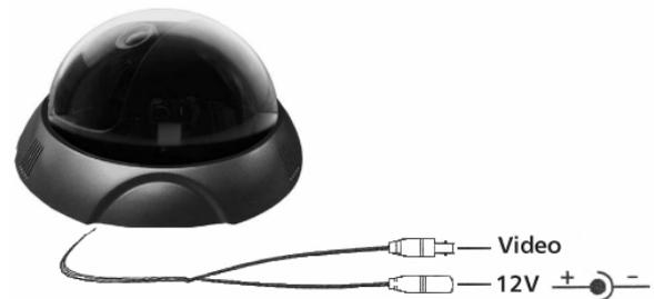
Schließen Sie den BNC-Videoausgang an einen Monitor oder einen Recorder über 75  $\Omega$  Koaxialkabel (z.B. RG 59) und danach die Stromversorgung über die 12V-Buchse an (empfohlene Netzgeräte: NG 500 S oder OTTO 12/500, 12V DC stabilisiert). Beachten Sie die Pol-Anschlüsse.
