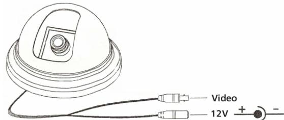
Schließen Sie den BNC-Videoausgang an einen Monitor oder einen Recorder über 75  $\Omega$  Koaxialkabel (z.B. RG 59) und danach die Stromversorgung über die 12V-Buchse an (empfohlene Netzgeräte: NG 500 S oder OTTO 12/500, 12V DC stabilisiert). Beachten Sie die Pol-Anschlüsse.
