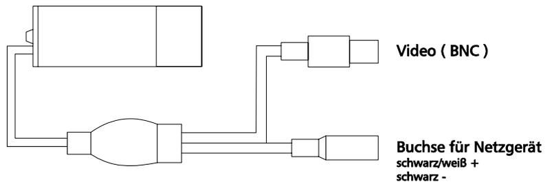
Schließen Sie den BNC-Videoausgang an einen Monitor oder einen Videorecorder über Koaxialkabel und danach die Stromversorgung über die 12V-Buchse an.
