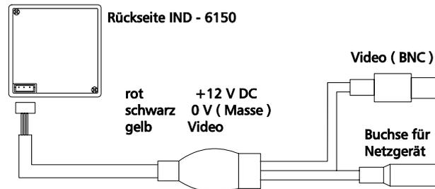
Schließen Sie den BNC-Videoausgang an einen Monitor oder einen Videorecorder über Koaxialkabel und danach die Stromversorgung über die 12V-Buchse an. Beachten Sie die Pol-Anschlüsse (auf der Buchse angegeben). Sollte kein Bild vorhanden sein, prüfen Sie als erstes die Stromversorgung sowie die Verbindung an der Netzgerät-Buchse. Die Stecker am Netzgerät sind unterschiedlich. Falls notwendig, biegen Sie die Kontakte leicht, um eine feste Verbindung zu gewährleisten.
